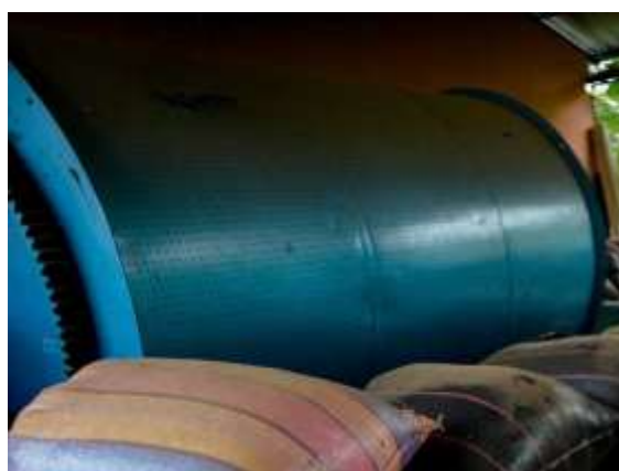
Foto N.- 8 Horno de secado artificial para el café pergamino sin mucilago.
