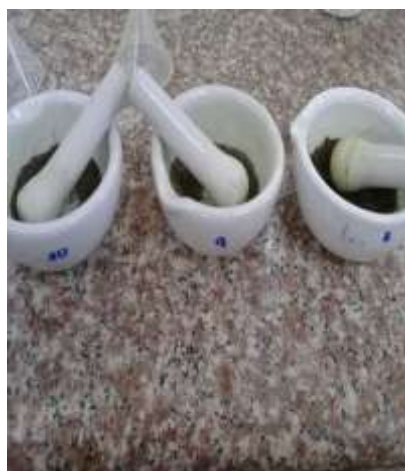
Trabajo de laboratorio, macerado de muestras para obtención de materia seca.
