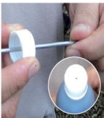
Perforación del difusor
